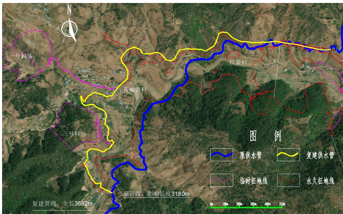
图 6.3-6 供水管道复建平面布置图
