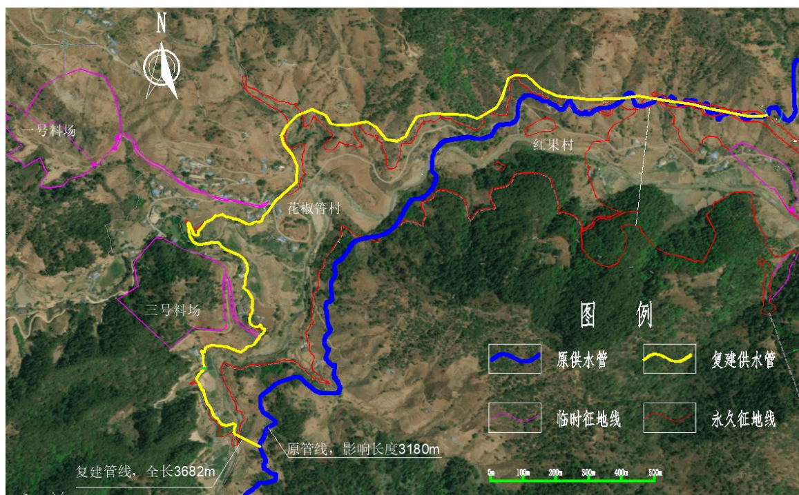
图 8.4-7 供水管道复建方案布置图
